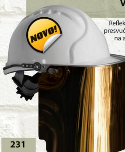
Reflektivni vizir optičke klase 1 presvučen 24-karatnim zlatom na aluminijskom nosaču, reflektuje toplotu i štiti oči od infracrvenog zračenja, pruža zaštitu od čestica brzine do 120 m/s, prskanja tečnosti i topljenog metala.
