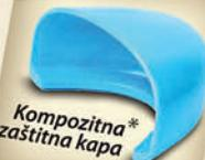
\*Proizvedena od laganog, termoizolujućeg, nemagnetnog, antikorozivnog i antialergijskog materijala koji je i do 50% lakši od klasične čelične kape.
